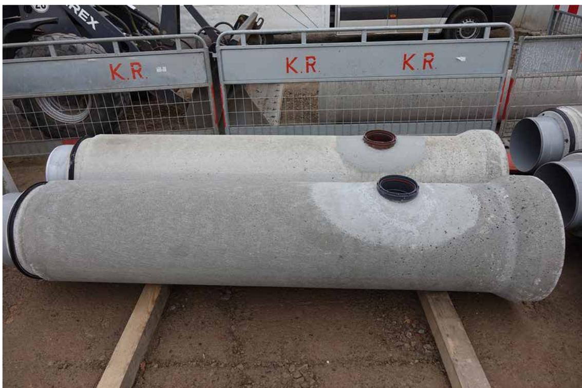
Bei FABEKUN<sup>®</sup>-Abzweigen handelt es sich um ein flexibles Kugelgelenk, das an der gewünschten und statisch zulässigen Stelle in einem FABEKUN<sup>®</sup>- Kanalrohr werkseitig eingebaut wird.
