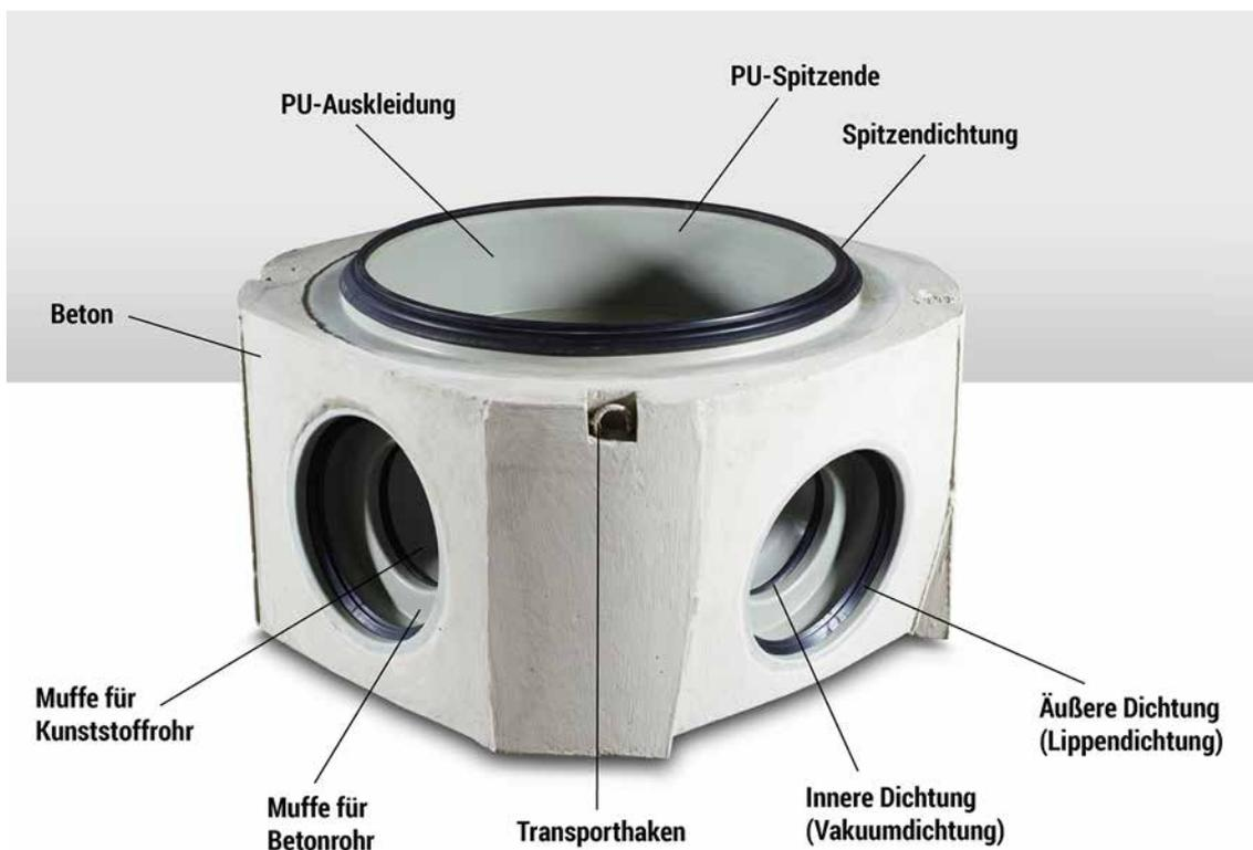
Das FABEKUN<sup>®</sup>-Schachtunterteil ist komplett mit PU ausgekleidet. Die Infiltration von Grundwasser, gerade im Bereich der Muffen und Fugen, ist nicht möglich.
