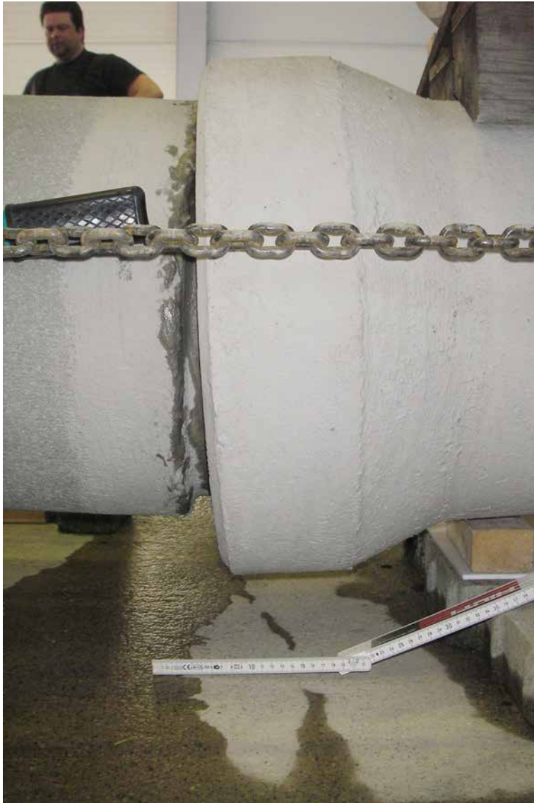
Dichtigkeitsprüfung unter vergrößerter Abwinkelung. .
